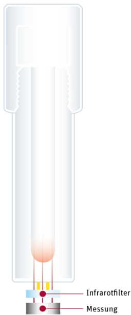
Bild 2: In situ Messprinzip zur Bestimmung der Probentemperatur
